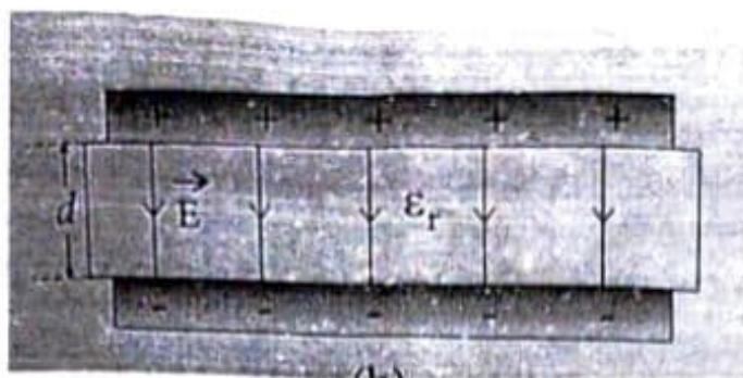
$$C_0 = \frac{Q_0}{V_0}, \quad E = \frac{E_0}{\epsilon_r} = 1 \text{ மதிப்பெண்}$$
