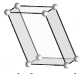
முச்சரிவு வடிவம் Triclinic a \neq b \neq c \alpha \neq \beta \neq \gamma \neq 90^\circ
