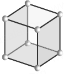
கனச்சதுரம் cubic a = b = c \alpha = \beta = \gamma = 90^\circ
